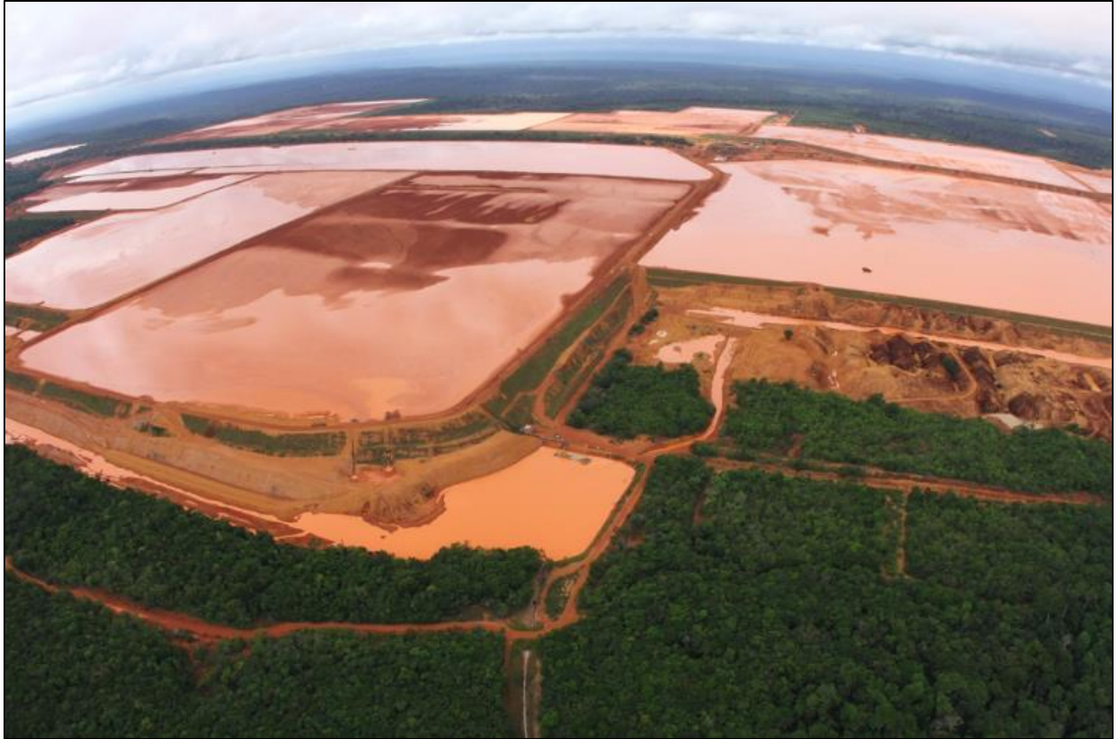
Figura 3. Uma imagem feita por drone mostra um alto nível de água sobrenadante em todas as barragens de rejeitos visíveis. Foto do Angelo (2024).
